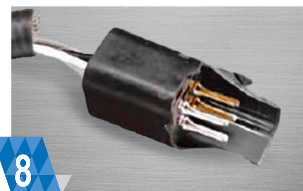
8 ПРОБЛЕМИ З РОЗ'ЄМАМИ (усі датчики) Кородовані або нещільно закріплені роз'єми, що спричиняють погане електричне з'єднання.
