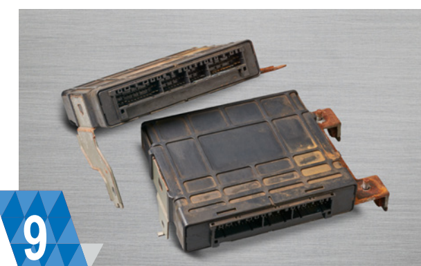
9 ПРОБЛЕМИ З ЕЛЕКТРОННИМ БЛОКОМ КЕРУВАННЯ (усі датчики) У рідкісних випадках електронний блок керування (ЕБК) може бути несправним і неправильно інтерпретувати сигнали датчиків.
