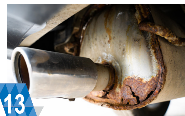
13 ВИТОКИ ВИХЛОПНИХ ГАЗІВ (для DPS, EGT, лямбда й NOx) Витоки у впускній системі (до й після DPF або каталітичного нейтралізатора) або впускній системі можуть призвести до некоректних показань датчика.
