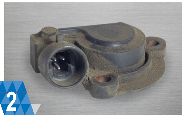
2 ЗАБРУДНЕННЯ (усі датчики) Пил, бруд й олива можуть накопичуватися на датчику, що впливає на точність його роботи.
