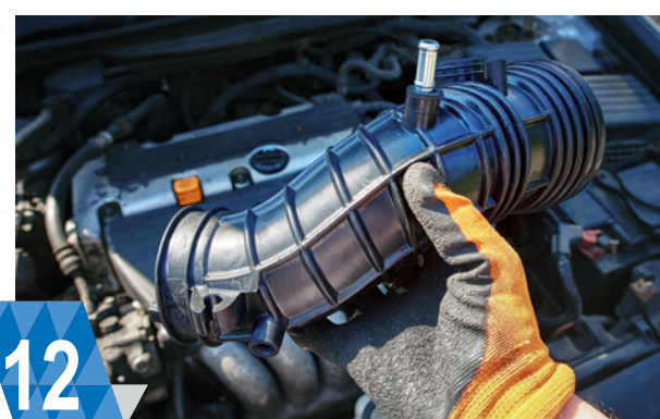
12 НЕГЕРМЕТИЧНІСТЬ (для MAF) Негерметичність у впускній системі може призвести до надлишкового потрапляння повітря, що призводить до неточних показників датчика MAF.
