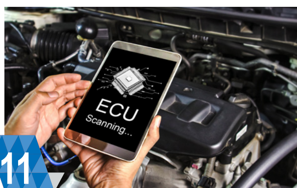
11 ПРОБЛЕМИ З КАЛІБРУВАННЯМ І ПРОГРАМНИМ ЗАБЕЗПЕЧЕННЯМ (усі датчики) Неправильне калібрування датчика або несправне програмне забезпечення ЕБК можуть призвести до встановлення неправильних цифрових кодів несправностей (DTC).
