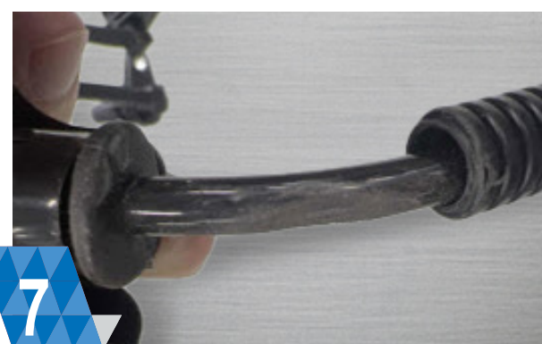
7 ЕЛЕКТРИЧНІ НЕСПРАВНОСТІ (усі датчики) Короткі замикання, розімкнені контури або електричні несправності в системі проводки автомобіля можуть спричинити несправності датчиків. Неправильна подача напруги або проблеми із заземленням також можуть призвести до неправильної роботи датчика.
