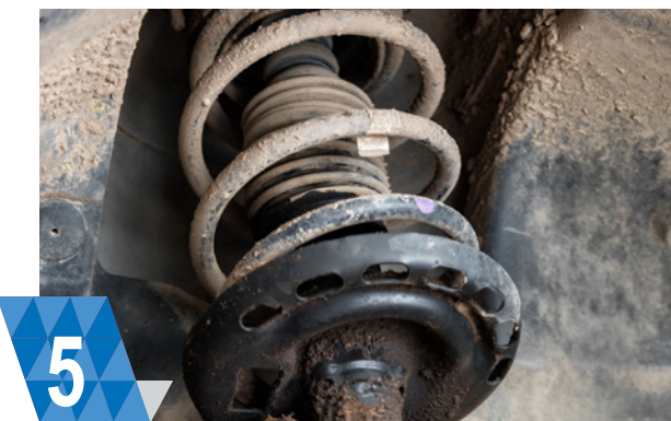
5 НАДМІРНА ВІБРАЦІЯ (усі датчики) Дорожні вібрації, зношені деталі підвіски або неправильний момент затягування послаблюють з'єднання або пошкоджують датчики.
