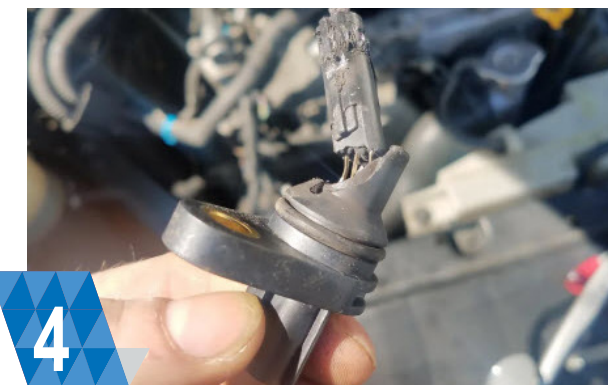
4 МЕХАНІЧНЕ ПОШКОДЖЕННЯ (усі датчики) Фізичне пошкодження датчика внаслідок неправильного поводження або удару.
