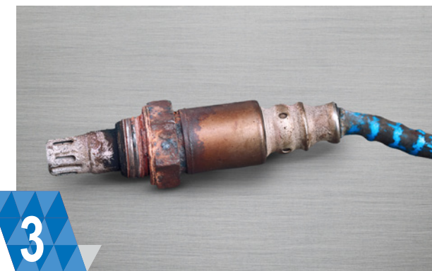
3 КОРОЗІЯ ДАТЧИКА (усі датчики) Волога й сіль спричиняють корозію роз'ємів датчика.
