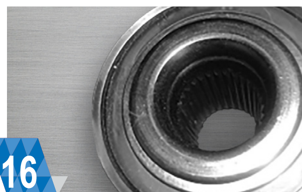
16 НЕСПРАВНЕ КІЛЬЦЕ ДАТЧИКА (для CMP, CKP та WSS) Тріснуті або зношені кільця датчиків надають неточні дані.
