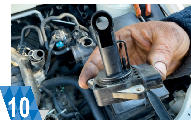
10 СТАРІННЯ ТА ЗНОС ДАТЧИКІВ (усі датчики) З часом датчики можуть зношуватися через нормальне старіння. Внутрішні компоненти датчика можуть стати менш чутливими, що призводить до сповільнення часу реакції або неправильних показників.
