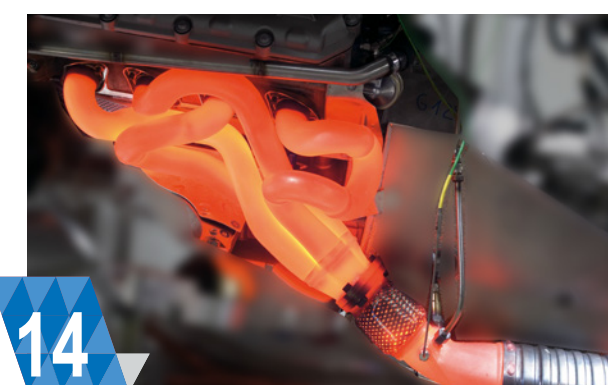
14 ПОШКОДЖЕННЯ ВНАСЛІДОК ВИСОКИХ ТЕМПЕРАТУР (для DPS, EGT, лямбда й NOx) Тривалий вплив екстремально високих температур може призвести до деградації датчика. Повторна циклічна зміна температури (нагрівання та охолодження) може призвести до тріщин або пошкодження внутрішніх компонентів датчика.
