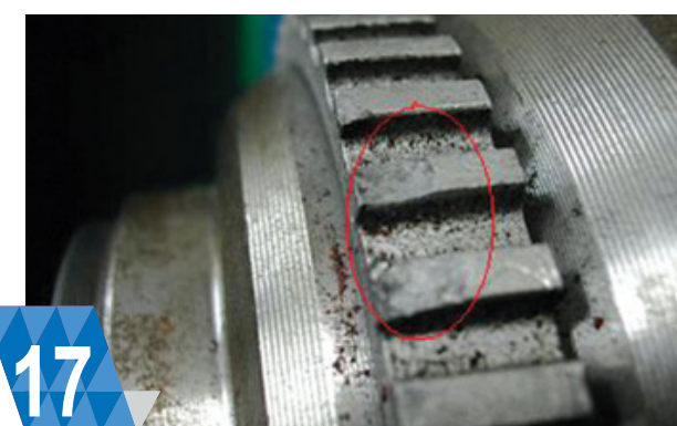
17 ПОШКОДЖЕННЯ ЗУБЧАСТОГО КІЛЬЦЯ (для датчиків індуктивності CMP, CKP та WSS) Пошкодження, зміщення або надмірне забруднення кільця (зубчасте колесо, яким датчик зчитує показання) може призвести до неправильних показників.
