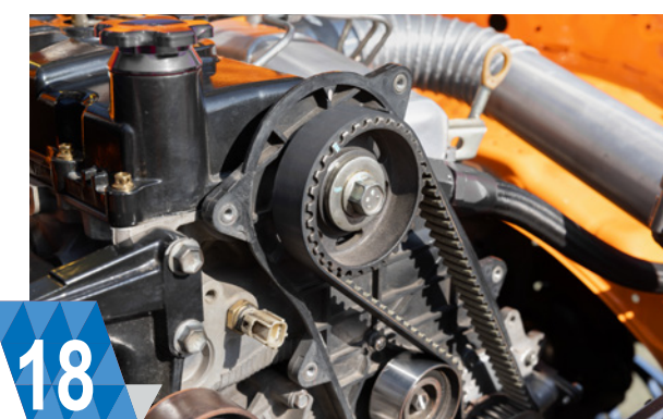
18 ПОМИЛКИ СИНХРОНІЗАЦІЇ (для датчика CMP) Зношені або неправильно встановлені ремені або ланцюги ГРМ, що впливають на положення розподільного вала.
