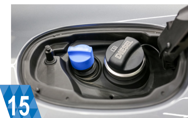
15 НИЗКА ЯКІСТЬ РІДИНИ ВІДНОВЛЮВАЧА SCR (для NOx та EGT) Забруднений або неправильний хімічний склад може вплинути на показники датчика.
