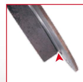
**ВНЕШНИЙ ВИД** Глубокие канавки между шляпкой и поверхностью диска
